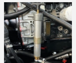
Pompa estrazione olio Oil drain pump
