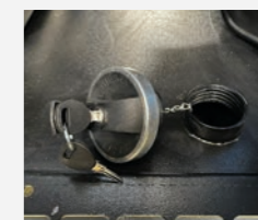
Bocchetta rifornimento carburante con serratura Lockable fuel filler
