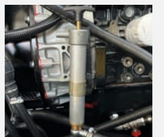
Pompa estrazione olio Oil drain pump
